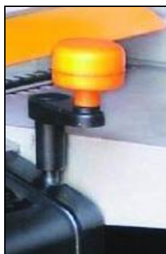
→ Manivelle d'ajustement de hauteur en mode rabot
